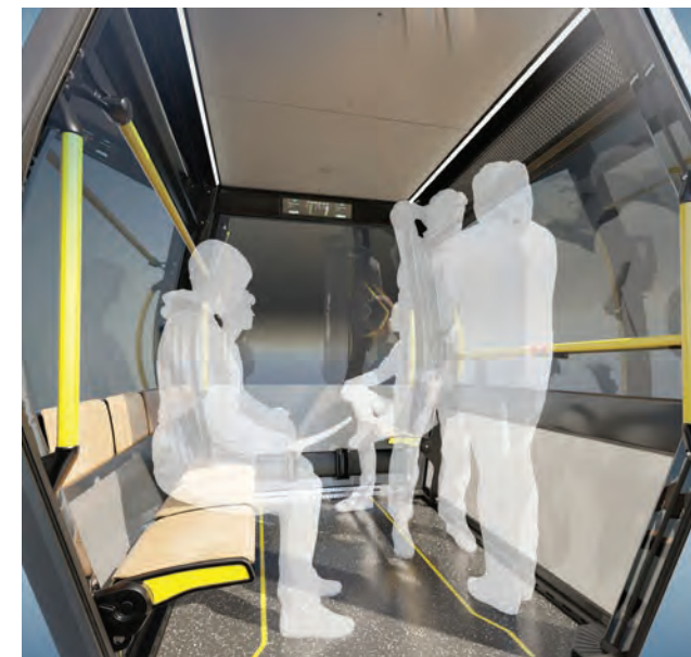
Configuration of the 12-passenger «URBAN» Gondola
