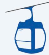
El sistema monocable se basa en un solo cable que actúa simultáneamente como cable portador y tractor. Las cabinas desembragables reducen su velocidad en las estaciones hasta alcanzar una velocidad de abordaje que permite un fácil acceso para todos los usuarios.
