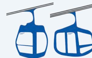
Los sistemas de dos y tres cables son propulsados por un cable tractor y se basan en uno o dos cable(s) portador(es). Estos sistemas ofrecen mayores capacidades en la línea, cabinas más grandes, cruces más largos y una resistencia superior al viento.
